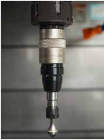
機械取付けイメージ ※ミールリングチャックで把握
