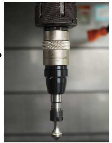
ภาพการติดตั้งที่เครื่องจักร *ยึดด้วยหัวจับเครื่องกัด
